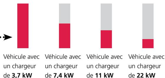
Une voiture compacte avec une batterie de 22 kWh peut être rechargée par exemple avec une station de recharge domestique AMTRON® de 22 kW en une heure environ lorsque le véhicule est équipé d'un chargeur de 22 kW. Le même véhicule peut aussi être chargé avec une station de recharge domestique de 3,7 kW.
